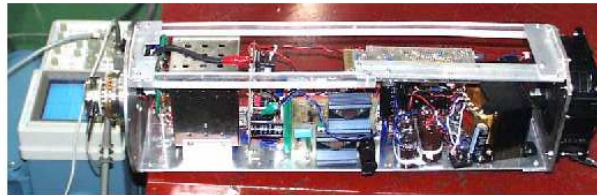
カソード・グリッド間に高電圧ゲートパルス信号を印加し、バンチを形成 → グリッドパルサー
