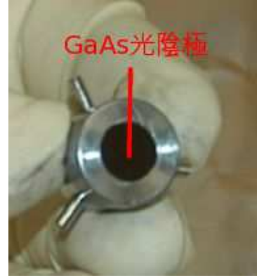
図 3.4: GaAs 光陰極。厚さ 0.35mm のウェハをナイフで切り出して、陰極として使用する。内径 8mm のキャップをかぶせることにより、陰極として使える範囲を制限している。
